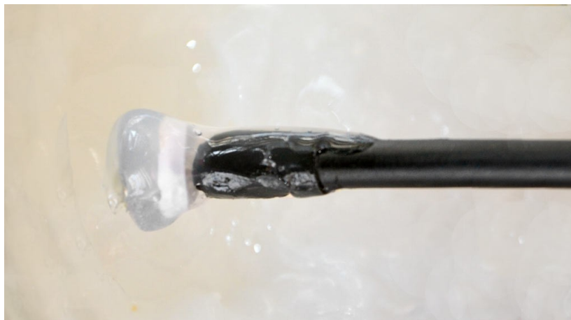
Ёмкостная пластина датчика Cx смазана диэлектрической смазкой.
