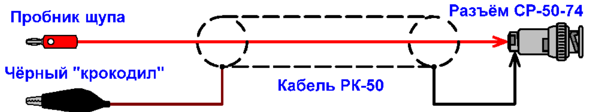
Схема распиновки осциллографического щупа.
